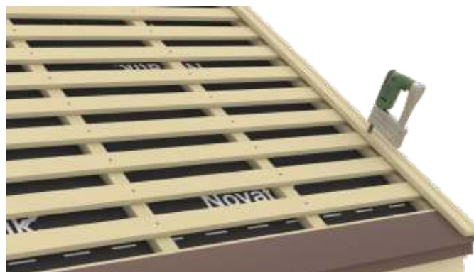
Fig.5. Montajul șipcii de lemn în zona paziei
