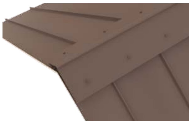
fig.48 Exemplu coamă montată
