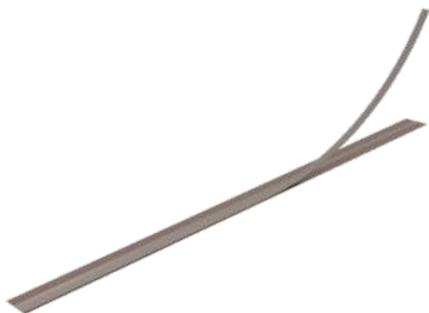
fig.44 Aplicarea benzii butilice pe racordul de îmbinare
