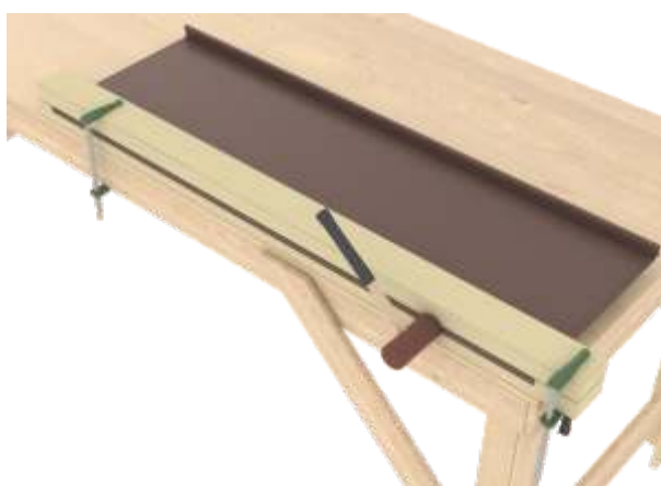
fig.50 Folosirea mesei de lucru pentru realizarea falțului lateral
