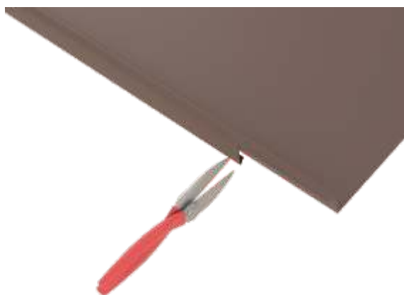
fig.33 Decupajul panoului care urmează să fie montat
