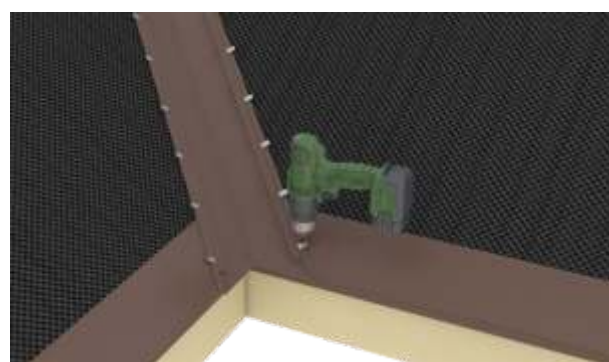
fig.24 Fixarea doliei cu ajutorul agrafelor, pe suportul de scândură
