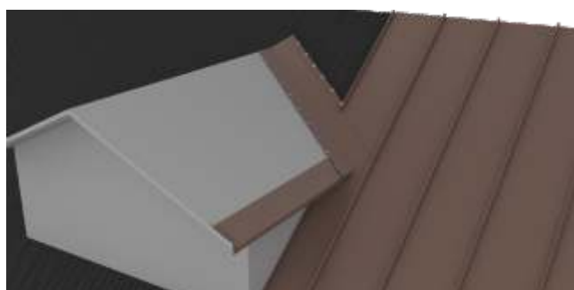
fig.58 Montajul panourilor în zona de dolie
